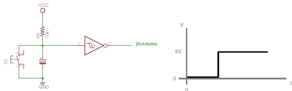
Al conectar la resistencia y el condensador en serie, reduciremos la constante de carga del condensador, y el Smith trigger se encargará de limpiar e invertir la señal.
