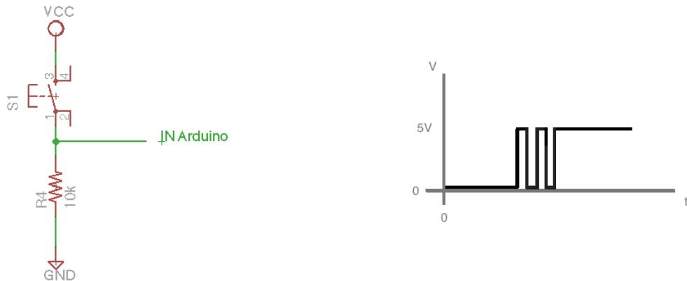
Una alternativa para solucionarlo es el uso de un Smith Trigger externo, en concreto el **HEF40106BP**.
